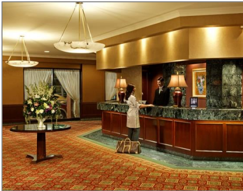
Figure 22 : pour les zones d'accueil (par exemple dans les hôtels), les gens optent généralement pour des températures de couleur chaudes (2700 à 3000K).
