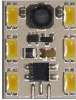
Figure 47 : module LED avec un circuit plus complexe pour convertir une tension en un courant constant.
