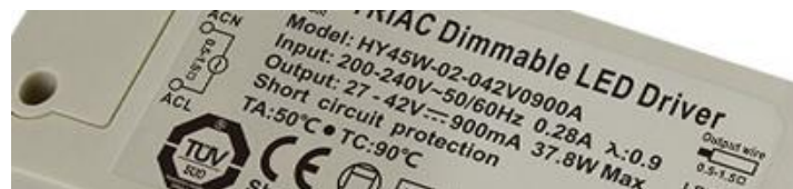
Figure 49 : alimentation constante : fournit 900 mA. La somme des tensions directes des LED's (connectées en série) doit être comprise entre 27 et 42V. L'alimentation ne fonctionnera pas correctement si trop peu de LED sont connectées !
