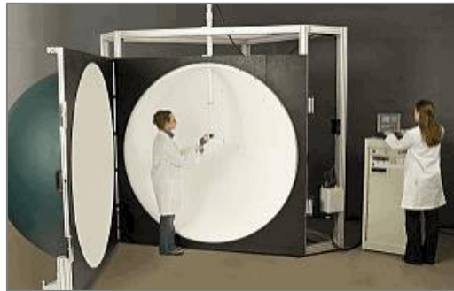
Figure 14 : sphère d'intégration ou Sphère de Ulbrich. La lampe est placée dans la sphère. Un détecteur, qui est protégé du rayonnement direct de la lampe, peut mesurer, grâce au revêtement blanc de la sphère, une moyenne de la lumière de la lampe. Le flux lumineux peut facilement être calculé à partir de cette moyenne.
