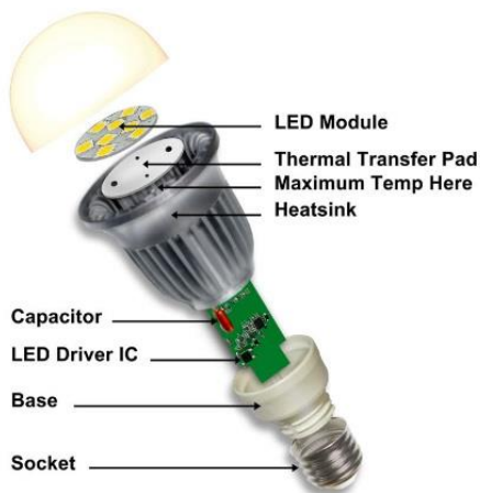
Figure 62 : lampe LED ouverte. Le driver LED dimmable est situé dans le culot de la lampe.
