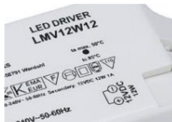
Figure 45 : une partie du marquage d'un driver LED pour pilotage en tension. Clairement reconnaissable à l'indication de tension et de puissance.
