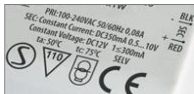
Figure 51 : driver LED universel : détermine automatiquement si une tension constante (12V) ou un courant constant (350mA) est requis pour les LED's connectées.
