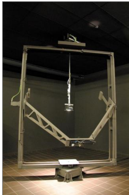
Figure 15 : photogoniomètre en champ proche. Une caméra tourne autour de la lampe. Le flux lumineux et les courbes photométriques peuvent être déterminés à partir des données ainsi mesurées.
