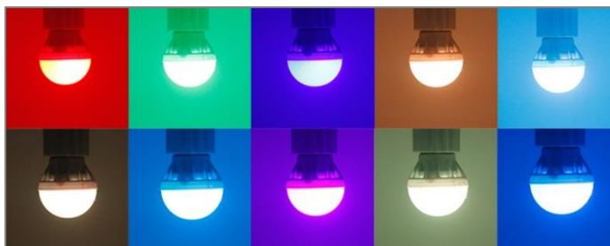
Figure 27 : en mélangeant des LED's de différentes couleurs, presque toutes les couleurs peuvent être obtenues. On utilise habituellement des LED's rouges, vertes et bleues, parfois complétées par des LED's blanches.
