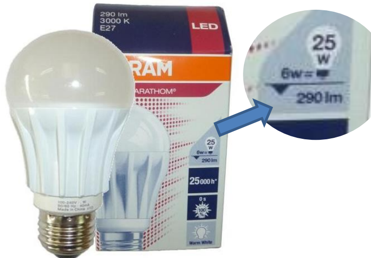
Figure 8 : cette lampe émet 290 lm. Le fabricant indique que cela correspond approximativement à une ampoule à incandescence de 25W. La puissance électrique d'une lampe LED (6W) n'est pas un bon outil de comparaison.
