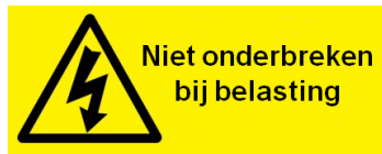
Figuur 32: voorbeeld van een waarschuwinglabel tegen onderbreken onder belasting
