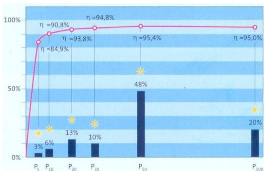
Figuur 54: grafische voorstelling van het EURO rendement van een omvormer
