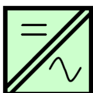
Figuur 51: omvormer met galvanische scheiding van het net
