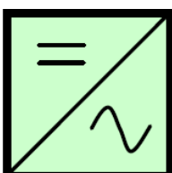
Figuur 50: omvormer zonder galvanische scheiding van het net
